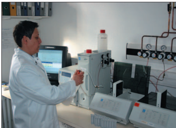
Identification d'explosifs minéraux par chromatographie ionique.
