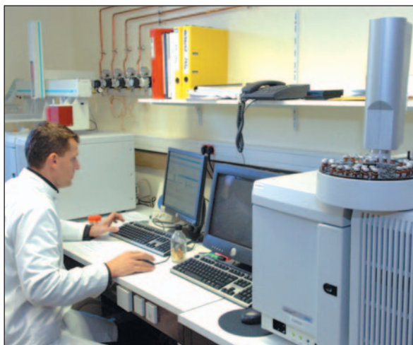
Analyses par chromatographie en phase gazeuse et spectrométrie de masse.
