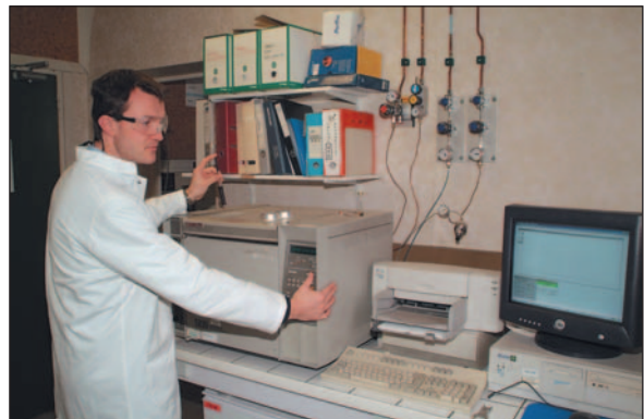
Caractérisation et datation d'un tir par mesures du taux d'échappement des HAP.
